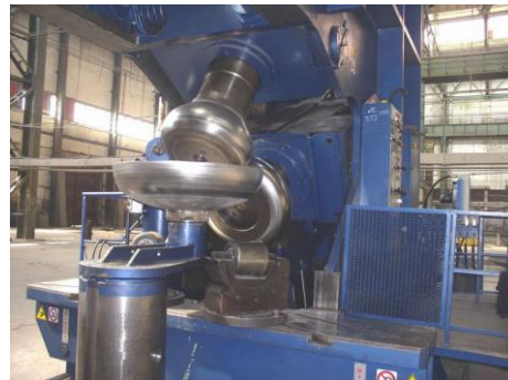
Рис. 58. Крупногабаритные днища диаметрами более 5 метров (элемент емкостного оборудования)
